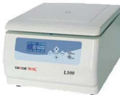
Control por microprocesador, motor eléctrico sin escobillas.
